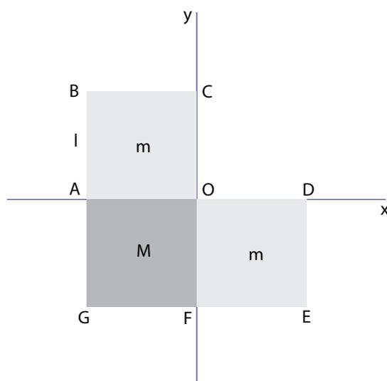
Una figura piana è costituita da due quadrati omogenei di massa  $m$  e da un terzo quadrato omogeneo di massa  $M$  disposti come in figura. Tutti i quadrati hanno lato  $l$ . Determinare la matrice d'inerzia nel sistema di riferimento. Infine, quanto deve valere  $M$  affinché il sistema di riferimento  $O(x, y)$  indicato sia principale d'inerzia?
