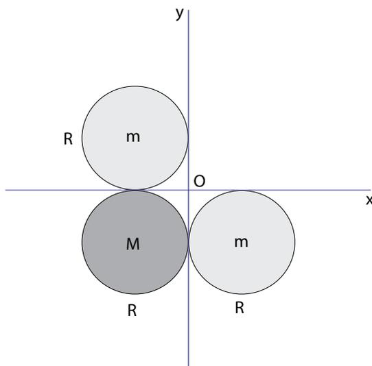
Una figura piana è costituita da due dischi omogenei di massa  $m$  e da un terzo disco omogeneo di massa  $M$  disposti come in figura. Tutti i cerchi hanno raggio  $R$ . Determinare la matrice d'inerzia nel sistema di riferimento. Infine, quanto deve valere  $M$  affinché il sistema di riferimento  $O(x, y)$  indicato sia principale d'inerzia?
