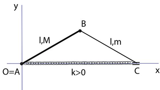
Una molla di costante  $k > 0$  collega l'estremo  $C$  della seconda asta con l'estremo fisso  $A$  della prima. Il moto del sistema si svolge su un piano verticale. Scrivere le equazioni di Lagrange ed esplicitare le reazioni vincolari interne ed esterne utilizzando le equazioni cardinali della dinamica (è sufficiente l'impostazione corretta, senza sostituire dalle equazioni del moto).
