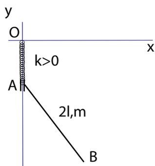
Una molla di costante  $k > 0$  collega l'estremo  $A$  con il punto fisso  $O$  della guida. Il moto del sistema si svolge su un piano verticale. Scrivere le equazioni di Lagrange ed esplicitare le reazioni vincolari utilizzando le equazioni cardinali della dinamica (è sufficiente l'impostazione corretta, senza sostituire dalle equazioni del moto).
