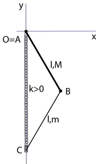
Una molla di costante  $k > 0$  collega l'estremo  $C$  della seconda asta con l'estremo fisso  $A$  della prima. Il moto del sistema si svolge su un piano verticale. Scrivere le equazioni di Lagrange ed esplicitare le reazioni vincolari interne ed esterne utilizzando le equazioni cardinali della dinamica (è sufficiente l'impostazione corretta, senza sostituire dalle equazioni del moto).
