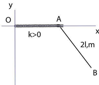
Una molla di costante  $k > 0$  collega l'estremo  $A$  con il punto fisso  $O$  della guida. Il moto del sistema si svolge su un piano verticale. Scrivere le equazioni di Lagrange ed esplicitare le reazioni vincolari utilizzando le equazioni cardinali della dinamica (è sufficiente l'impostazione corretta, senza sostituire dalle equazioni del moto).
